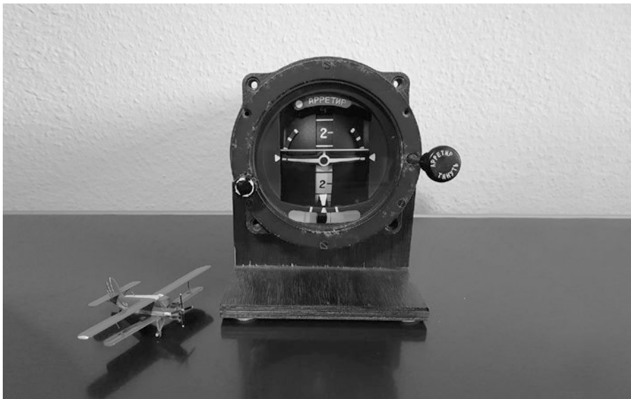
Abb. 6.1 Künstlicher (objektiver) Horizont: In turbulenten Situationen oder bei schlechter Sicht ( \triangleq negativem Hyperfokus) bietet der künstliche Horizont Sicherheit; fliegen nach Gefühl bedeutet Absturz. Instrument von Antonov An-2 = „Traktor der Lüfte“, eines der zuverlässigsten je gebauten Flugzeuge
