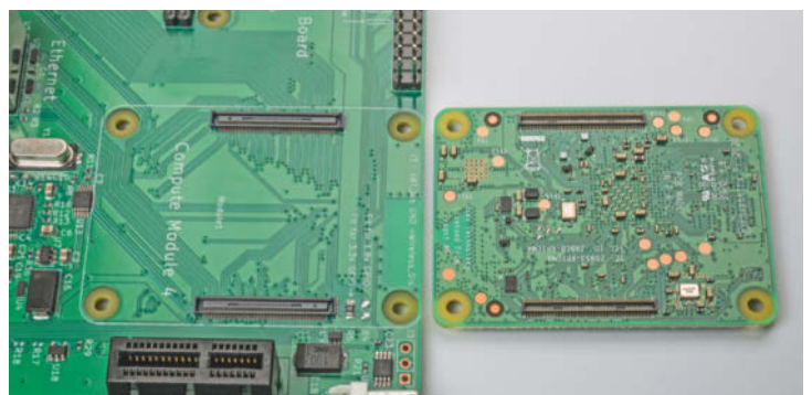
Zwei winzige längliche Steckverbinder mit je 100 Kontakten koppeln ein CM4 an das IO-Board.
