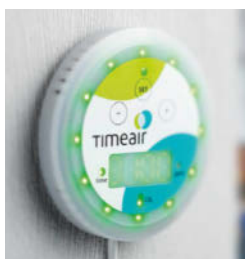
Im timeair-Gerät steckt ein CO 2 -Sensor und etwas Intelligenz, welche dabei helfen soll, rechtzeitig zu lüften, um Krankheitsübertragungen durch Aerosole zu vermeiden.
